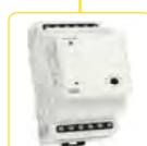
VRSF3, VRSF3N Hlídá pořadí fází a podpětí nebo výpadek fáze. Str.: 136
