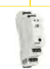
TER-7 Kontrola oteplení vinutí motoru v pásmu daném odporem zabudovaného PTC termistoru (1.8-3.3 kΩ), doplňující funkce (paměť, reset), výstupní kontakt 2x 8 A přep., napájení: AC/DC 24-240 V. Str.: 110
