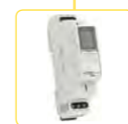
VS116K Napájecí napětí: AC 230 V a AC/DC 24 V Výstupní kontakt: 1x přepínací 16 A. Str.: 36
