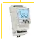
TER-9 2 teplotní vstupy, 2 výstupy 8 A přepínací, 6 funkcí, vestavěné spínací hodiny, podsvětlený LCD, galvanicky odd. napájení AC 230 V nebo AC/DC 24 V, 2 MODUL. Teplotní rozsah: -40 °C až +110°C. Str.: 108
