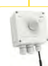
TEV-3 Termostat pro regulaci vytápění (chlazení), nastavitelný rozsah 5..+35 °C, externí senzor NTC, výstupní kontakt 16 A, ovládací potenciometr a indikace na panelu. Str.: 115
